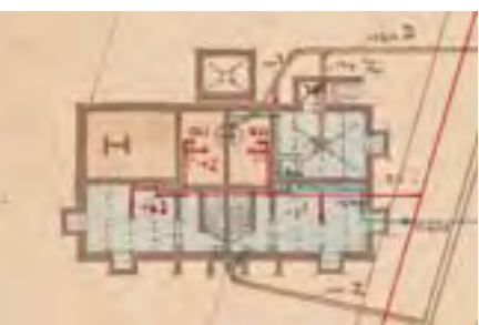
Oben: So sieht das erste Haus der Gartenstadt Ansbach heute aus. Aus dem Plan in der Mitte geht hervor, dass das Haus entgegen der ersten Idee längs zur Straße gedreht wurde. Im Plan unten werden Wasserzu- und -ableitung sowie die Gasleitungen (damals für Kochstelle und Zimmerbeleuchtung) genau bezeichnet.
